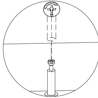
Nota: Asegurese de que la flecha indicadora del minifix quede alineada con el perno conector
