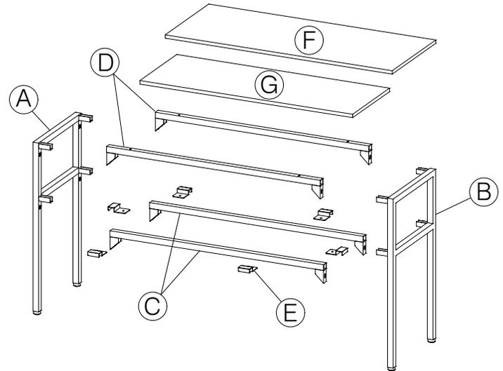
Nota: los travesaños (D) tienen orificios en la cara de arriba y abajo en ambos extremos
