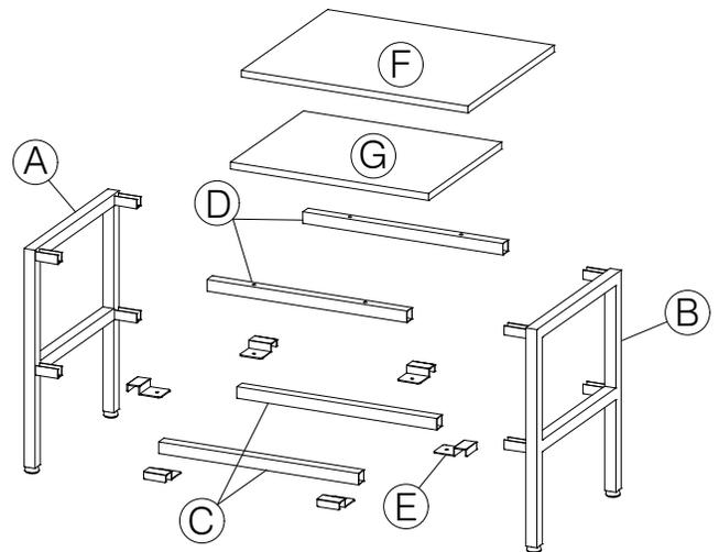
Nota: los travesaños (D) tienen orificios en la cara de arriba y abajo en ambos extremos
