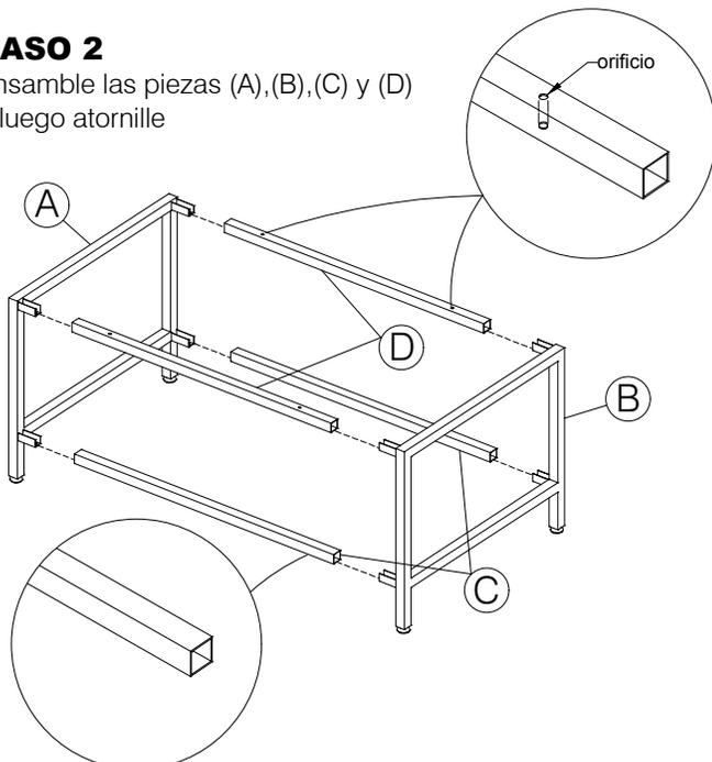
Nota: los travesaños (D) tienen orificios en la cara de arriba y abajo en ambos extremos
