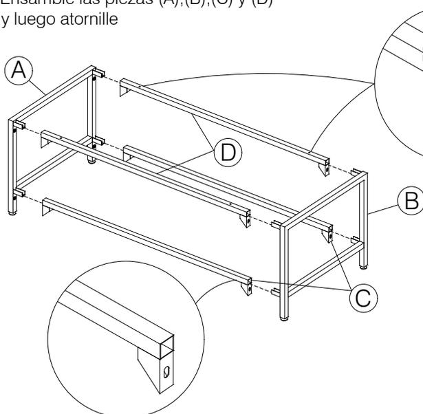
Nota: los travesaños (D) tienen orificios en la cara de arriba y abajo en ambos extremos
